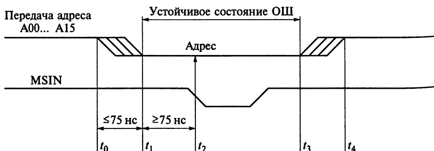
Рис. 7.4. Передача адреса по параллельной магистрали со стробированием
