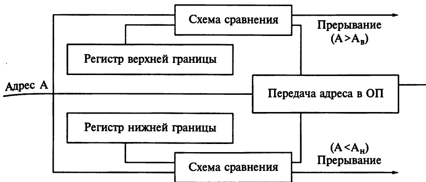
Рис. 6.10. Защита памяти методом граничных регистров
